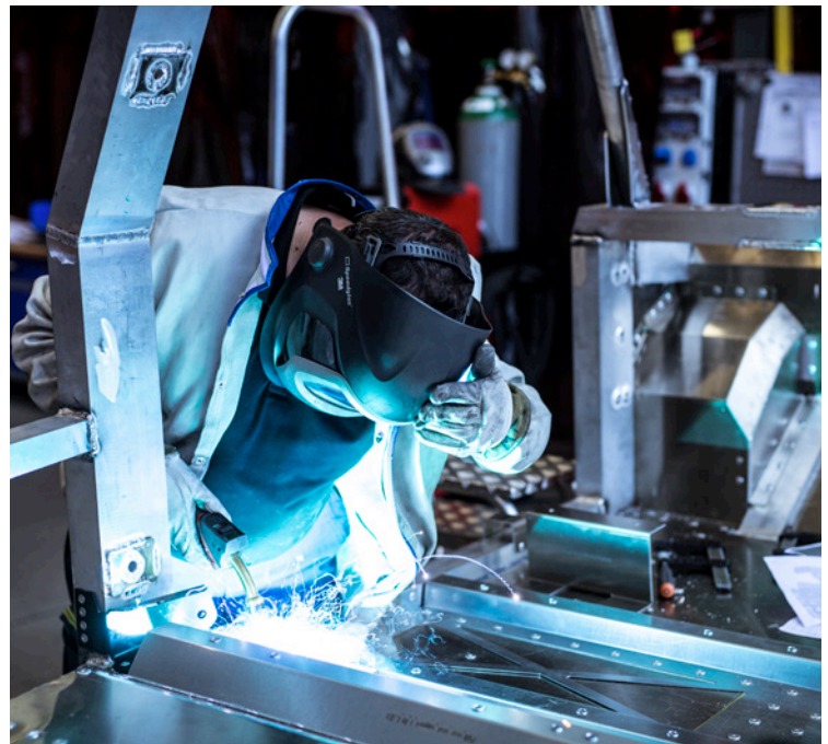
Foto 2: Aluminiumschweißen, Demonstrationsfabrik Aachen
